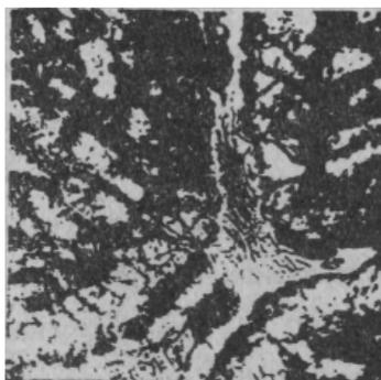
Рисунок 11.2 – Микроструктура стали Р6М5 после литья
